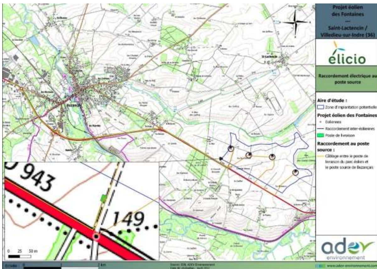
Carte 1 : Cartographie hypothétique du raccordement électrique du parc éolien au poste source (Source : ADEV Environnement)
